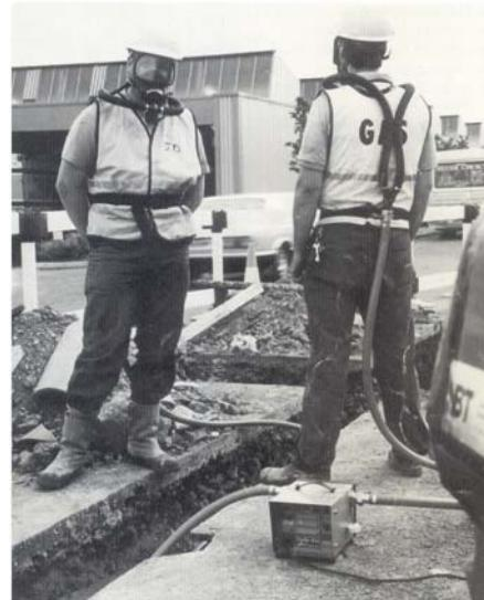
Osnovni dijelovi: 1. zaštitna maska, 2. priključak na zaštitnu masku, 3. odušni ventil (za suvišak zraka), 4. cijev za disanje, 5. cijev za dovođenje zraka, 6. spojnica, 7. opasač ili pojasma traka za nošenje, 10. vrećica za disanje, 11. ventilator (ručni), 12. ventilator (motorni) ili injektor na stlačeni zrak
